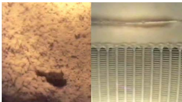
Video ispezione pozzo prima e dopo trattamento con BoreSaver Ultra C
